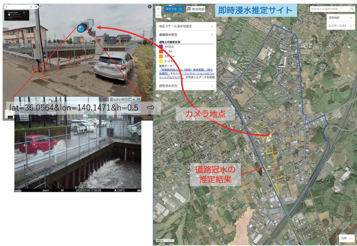
図 2. カメラ画像と即時浸水推定サイトの連携による周辺道路冠水状況の推定結果
