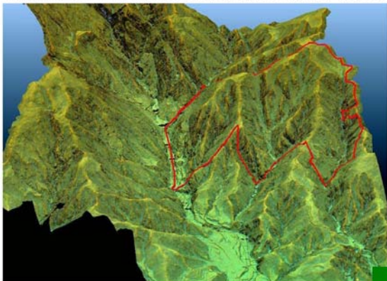
明らかな断層(リアメント)が見て取れる。この断層を通して、尾根を越えた地下水の流れが存在するらしい。
